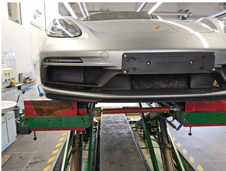
Bild 16 : Stoßfänger vorne, Kühler Steinschläge
