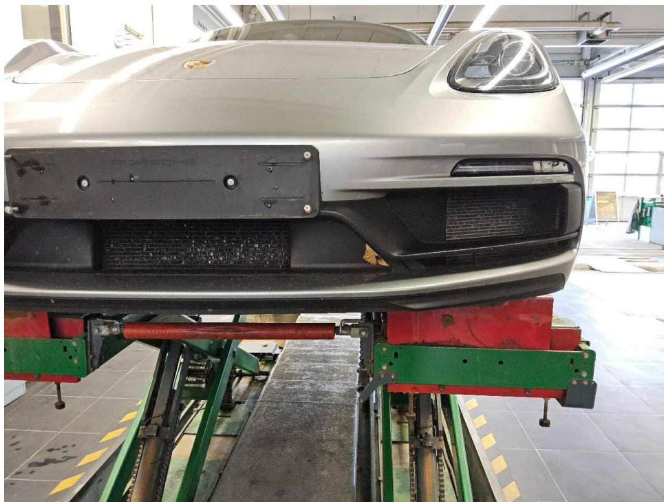
Bild 17 : Stoßfänger vorne, Kühler Steinschläge
