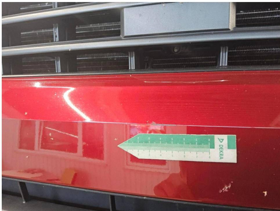
Bild 15 : Stoßfänger vorne Lackierung, zerkratzt, Gebrauchsspur
